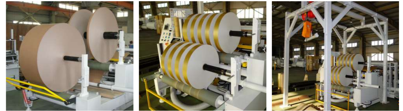
EG-2L 雙軸表面捲取分條機是一款以手動操作為主的機型，但具備處理大尺寸紙卷的強大能力。
